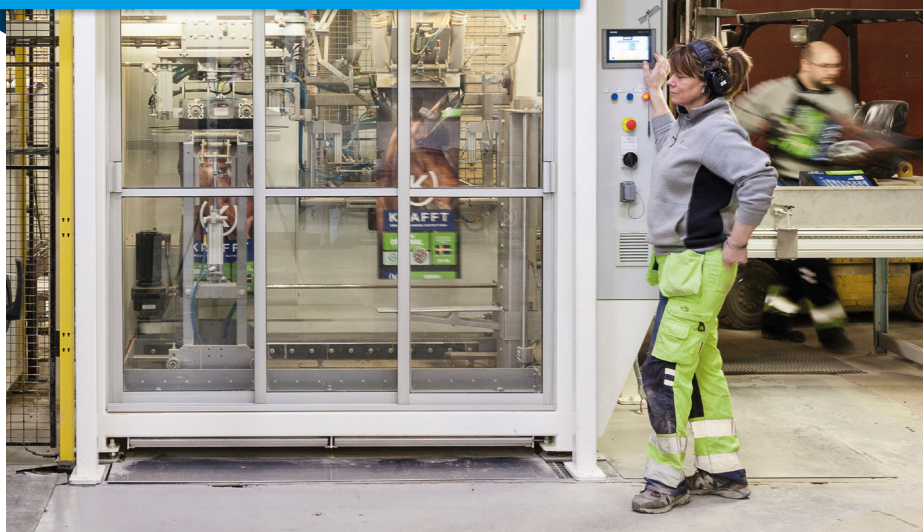
På Lantmännen Lantbruks säckanläggning i Falkenberg förpackas husdjursfoder. I dag använder man Vebe Teknics säckfyllare Autopac 2.20 för att packa en mängd olika fodertyper i limförslutna pinchsäckar.
